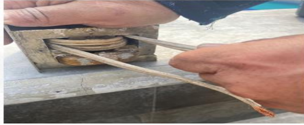
Fig. 7 colocando el cable y enrollándolo en el transformador
