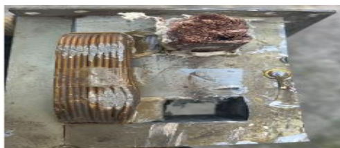
Fig. 6 eliminando el embobinado secundario
